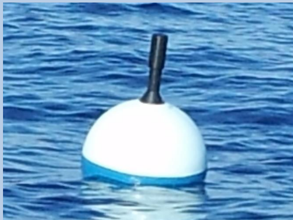
Дрейфующий в море океанографический буй, отслеживаемый со спутников
